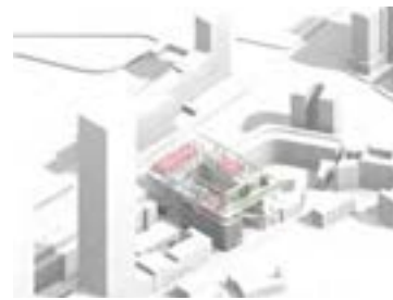
De luchtplint verbindt de drie bestaande gebouwen en de optopping erboven
