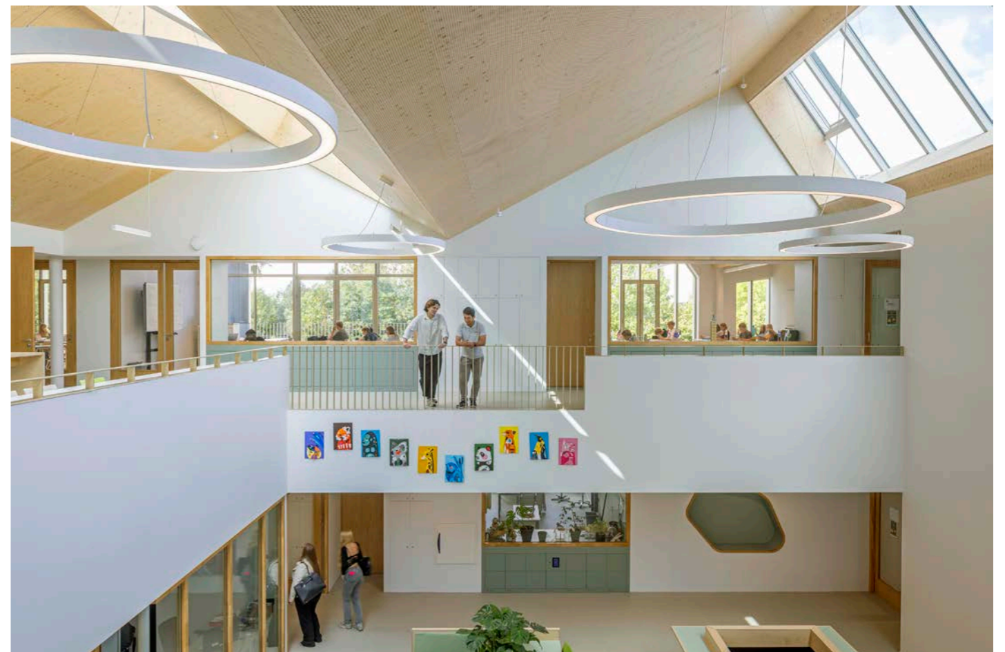
Via de noordgerichte daklichten strijkt indirect daglicht langs de kappen tot diep in het studiehart. De geperforeerde afwerking van Fins vurenhout zorgt voor een uitstekende akoestiek.
