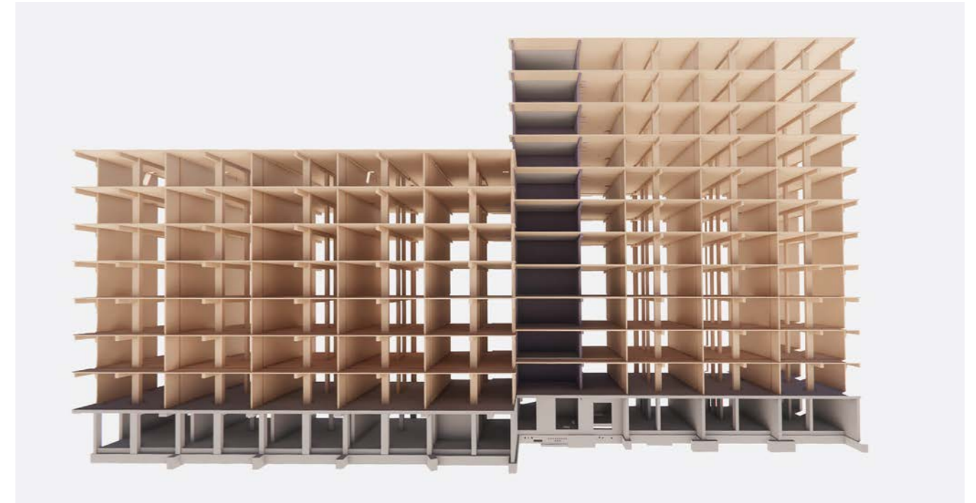
Een ritmische CLT-houtstructuur die de ruimtelijke kwaliteit van de appartementen optimaliseert.
